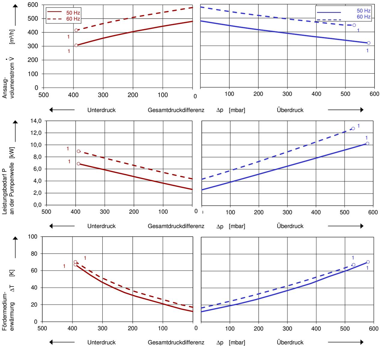
Die Kennlinien gelten für Fördermedium Luft von 15 °C und Atmosphärendruck von 1013 mbar mit einer Toleranz von  $\pm 10\%$ . Die maximal im Dauerbetrieb zulässigen Gesamtdruckdifferenzen gelten bis zu einer Ansaug- und Umgebungstemperatur von 25 °C. Bei anderen Bedingungen bitten wir um Rücksprache.
