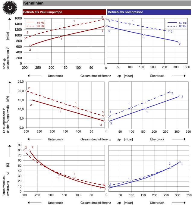
Die Kennlinien gelten für Fördermedium Luft von 15 °C und Atmosphärendruck von 1013 mbar mit einer Toleranz von ± 10 %. Die maximal im Dauerbetrieb zulässigen Gesamtdruckdifferenzen gelten bis zu einer Ansaug- und Umgebungstemperatur von 25 °C. Bei anderen Bedingungen bitten wir um Rücksprache.
