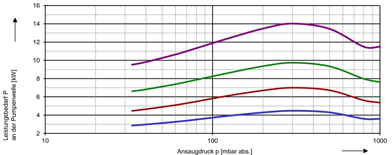
Die Kennlinien gelten bei Ansaugen von Luft mit 100 % relativer Feuchte und ein Ansaugtemperatur von 20 °C. Bei einem Atmosphärendruck von 1013 mbar abs. und einer Betriebsflüssigkeitstemperatur von 15 °C (Wasser als Betriebsflüssigkeit) werden die Kennliniendaten eingehalten. Die Toleranz beträgt ± 10 %.
