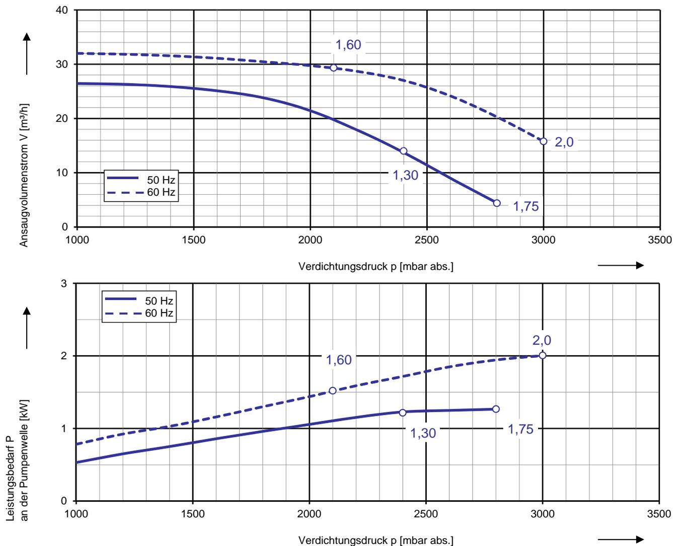
Die Kennlinien gelten bei Ansaugen von Luft mit 50 % relativer Feuchte und ein Ansaugtemperatur von 20 °C. Bei einem Atmosphärendruck von 1013 mbar abs. und einer Betriebsflüssigkeitstemperatur von 15 °C (Wasser als Betriebsflüssigkeit) werden die Kennliniendaten eingehalten. Die Toleranz beträgt ± 10 %.
