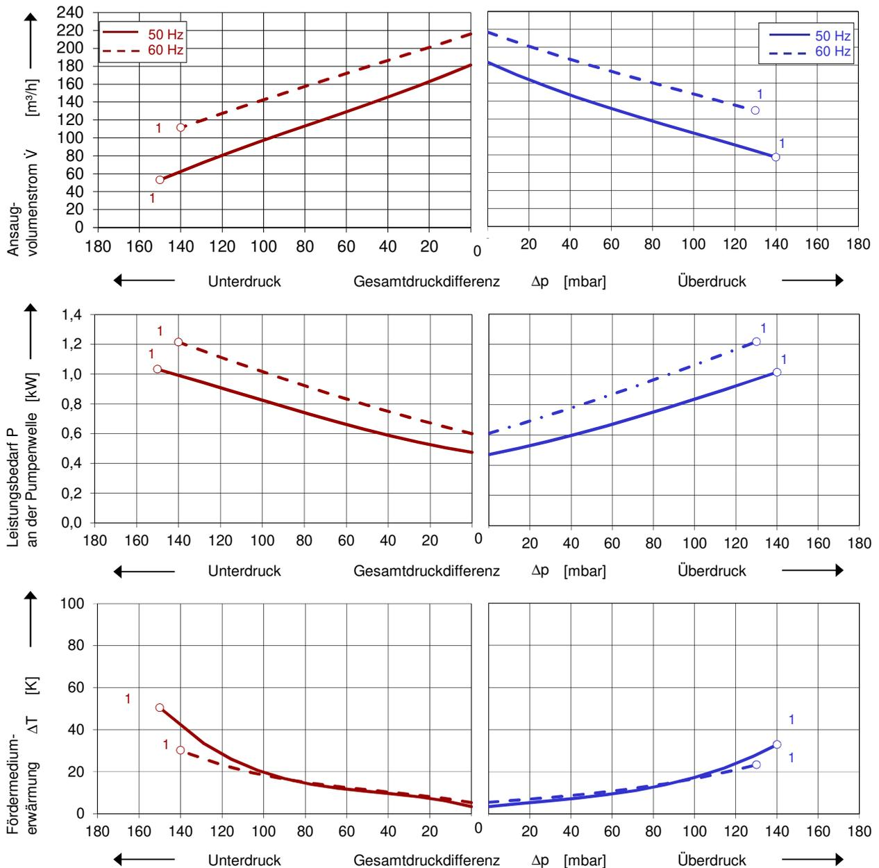
Die Kennlinien gelten für Fördermedium Luft von 15 °C und Atmosphärendruck von 1013 mbar mit einer Toleranz von  $\pm 10\%$ . Die maximal im Dauerbetrieb zulässigen Gesamtdruckdifferenzen gelten bis zu einer Ansaug- und Umgebungstemperatur von 25 °C. Bei anderen Bedingungen bitten wir um Rücksprache.
