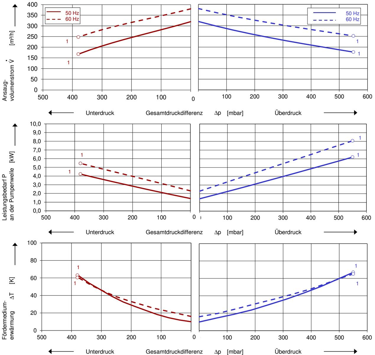
Die Kennlinien gelten für Fördermedium Luft von 15 °C und Atmosphärendruck von 1013 mbar mit einer Toleranz von ± 10 %. Die maximal im Dauerbetrieb zulässigen Gesamtdruckdifferenzen gelten bis zu einer Ansaug- und Umgebungstemperatur von 25 °C. Bei anderen Bedingungen bitten wir um Rücksprache.
