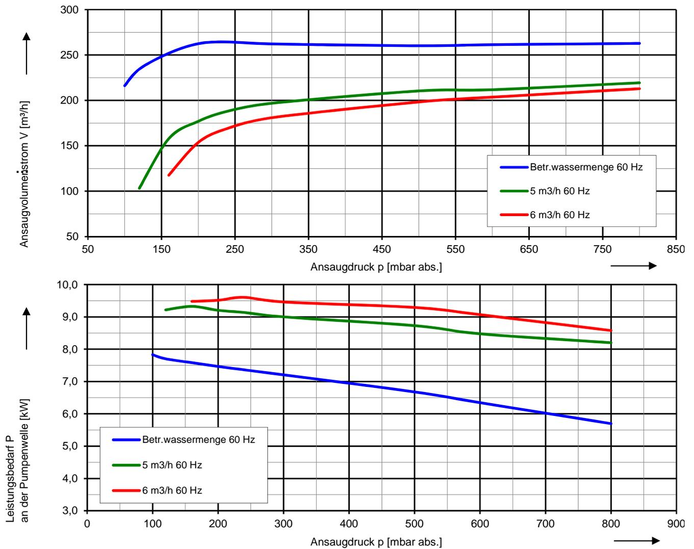
Die Kennlinien gelten bei Ansaugen von Luft mit 50 % relativer Feuchte und ein Ansaugtemperatur von 20 °C. Bei einem Atmosphärendruck von 1013 mbar abs. und einer Betriebsflüssigkeitstemperatur von 15 °C (Wasser als Betriebsflüssigkeit) werden die Kennliniendaten eingehalten. Die Toleranz beträgt  $\pm 10\%$ .
