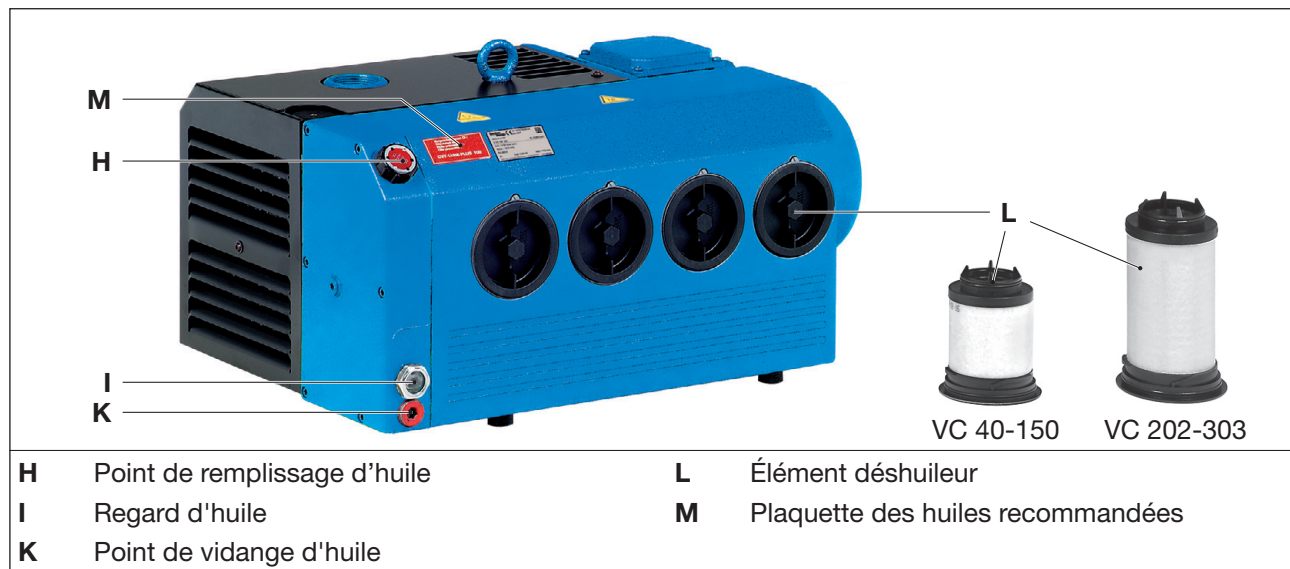
Fig. 7 Vidange d'huile et déshuilage
