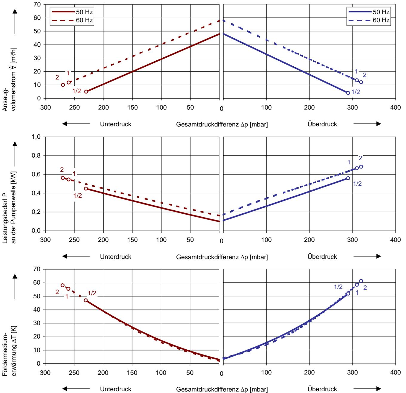
Die Kennlinien gelten für Fördermedium Luft von 15 °C und Atmosphärendruck von 1013 mbar mit einer Toleranz von  $\pm 10\%$ . Die maximal im Dauerbetrieb zulässigen Gesamtdruckdifferenzen gelten bis zu einer Ansaug- und Umgebungstemperatur von 25 °C. Bei anderen Bedingungen bitten wir um Rücksprache.
