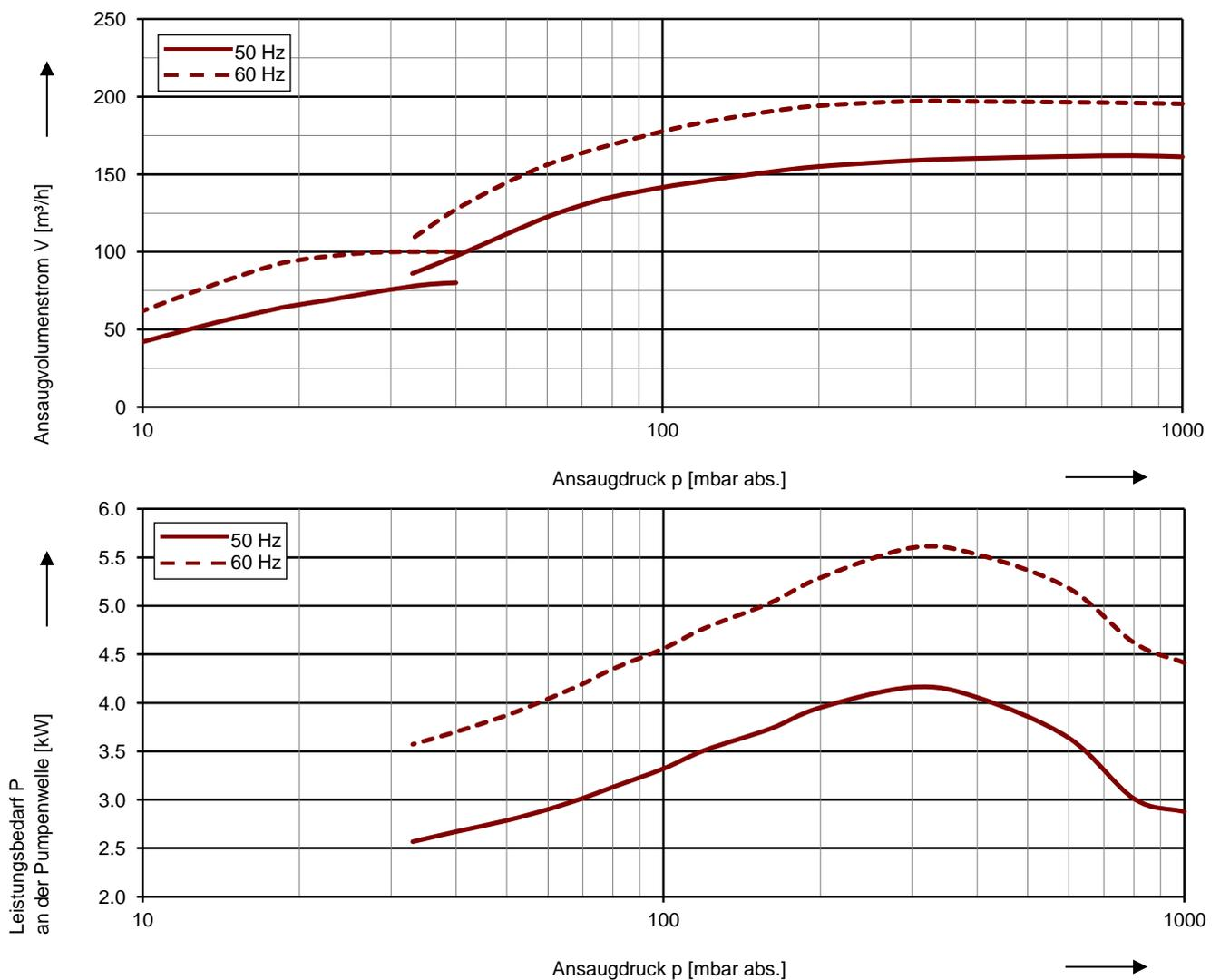
Die Kennlinien gelten bei Ansaugen von Luft mit 100 % relativer Feuchte und ein Ansaugtemperatur von 20 °C. Bei einem Atmosphärendruck von 1013 mbar abs. und einer Betriebsflüssigkeitstemperatur von 15 °C (Wasser als Betriebsflüssigkeit) werden die Kennliniendaten eingehalten. Die Toleranz beträgt ± 10 %.
