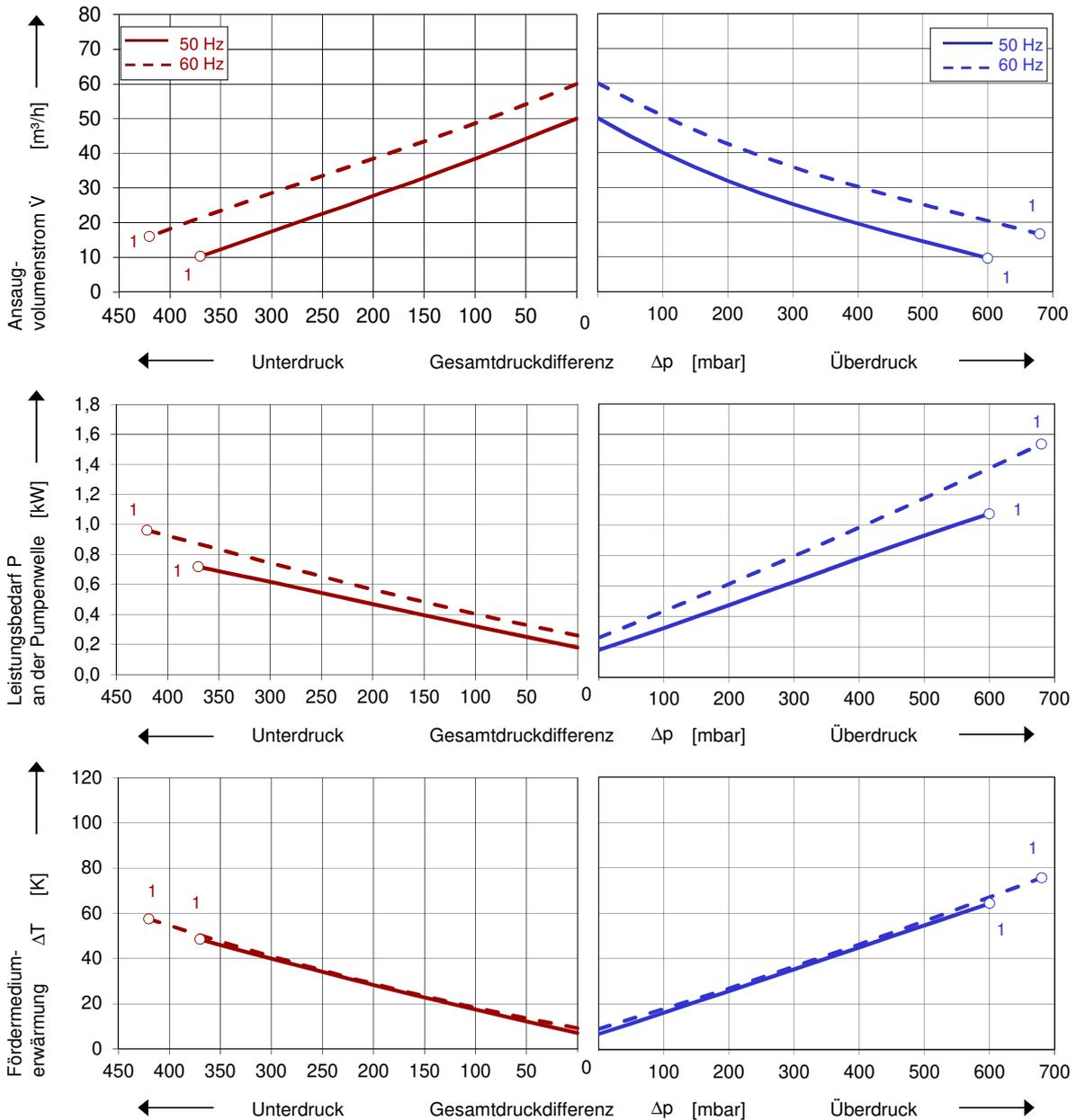
Die Kennlinien gelten für Fördermedium Luft von 15 °C und Atmosphärendruck von 1013 mbar mit einer Toleranz von  $\pm 10\%$ . Die maximal im Dauerbetrieb zulässigen Gesamtdruckdifferenzen gelten bis zu einer Ansaug- und Umgebungstemperatur von 25 °C. Bei anderen Bedingungen bitten wir um Rücksprache.
