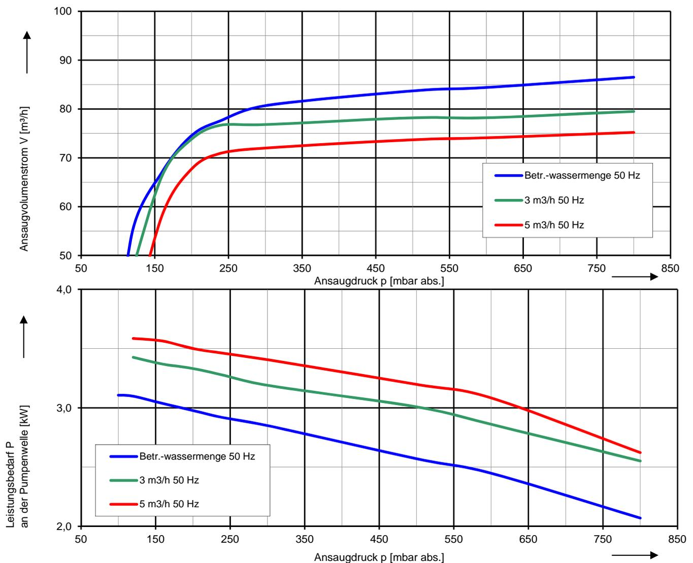
Die Kennlinien gelten bei Ansaugen von Luft mit 50 % relativer Feuchte und ein Ansaugtemperatur von 20 °C. Bei einem Atmosphärendruck von 1013 mbar abs. und einer Betriebsflüssigkeitstemperatur von 15 °C (Wasser als Betriebsflüssigkeit) werden die Kennliniendaten eingehalten. Die Toleranz beträgt  $\pm 10$  %.
