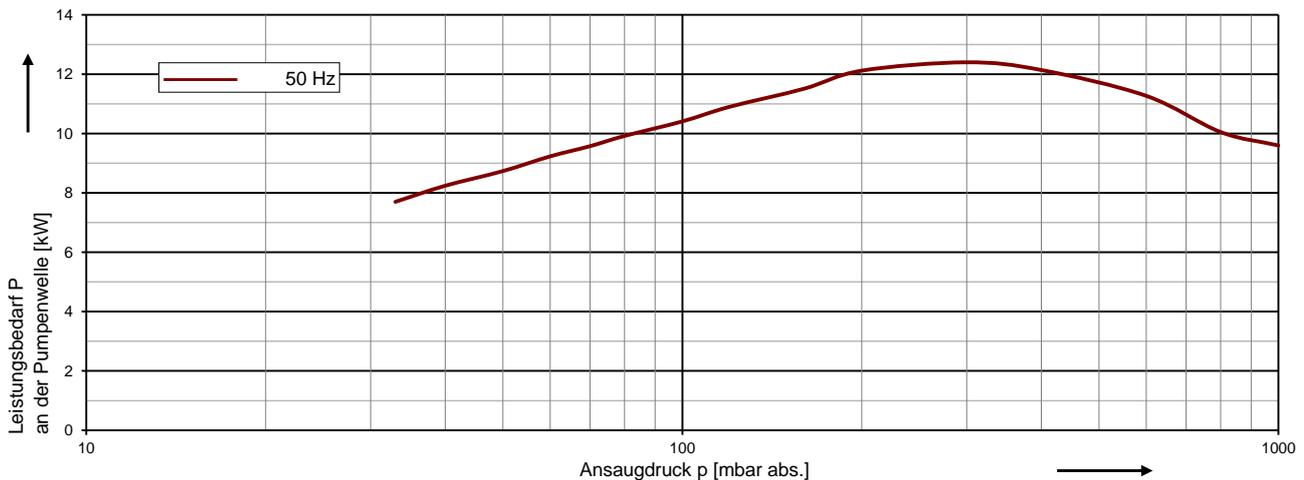
Die Kennlinien gelten bei Ansaugen von Luft mit 100 % relativer Feuchte und ein Ansaugtemperatur von 20 °C. Bei einem Atmosphärendruck von 1013 mbar abs. und einer Betriebsflüssigkeitstemperatur von 15 °C (Wasser als Betriebsflüssigkeit) werden die Kennliniendaten eingehalten. Die Toleranz beträgt  $\pm 10\%$ .
