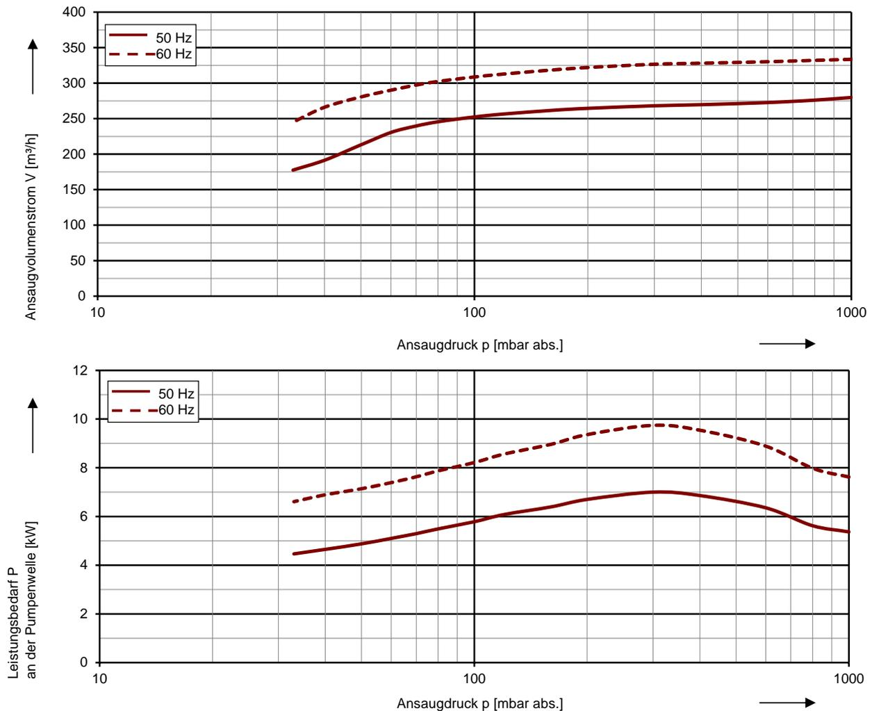
Die Kennlinien gelten bei Ansaugen von Luft mit 100 % relativer Feuchte und ein Ansaugtemperatur von 20 °C. Bei einem Atmosphärendruck von 1013 mbar abs. und einer Betriebsflüssigkeitstemperatur von 15 °C (Wasser als Betriebsflüssigkeit) werden die Kennliniendaten eingehalten. Die Toleranz beträgt  $\pm 10\%$ .
